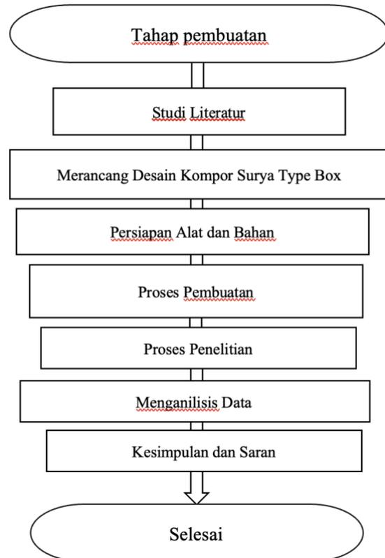
Gambar 1.2 Diagram Alir Proses Pembuatan Solar Cooker Tipe Box
