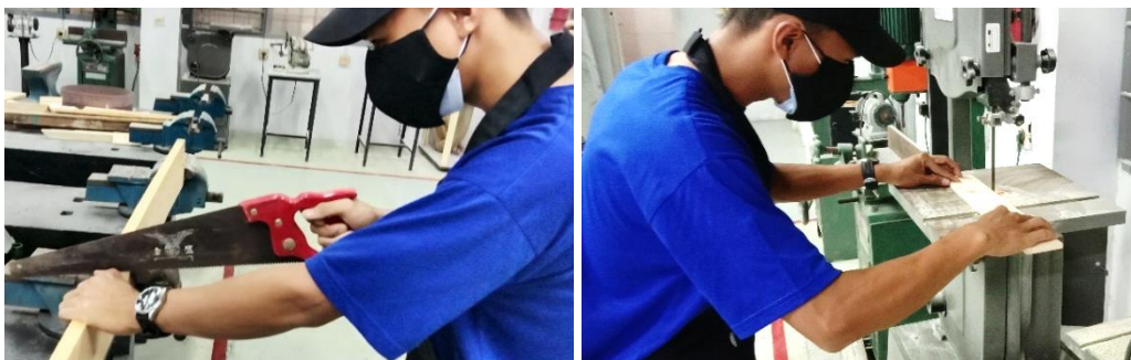
Gambar 3. Proses pemotongan kayu dengan gergaji (kiri), dan penggunaan alat circular saw untuk memotong kayu sesuai pola (kanan)
