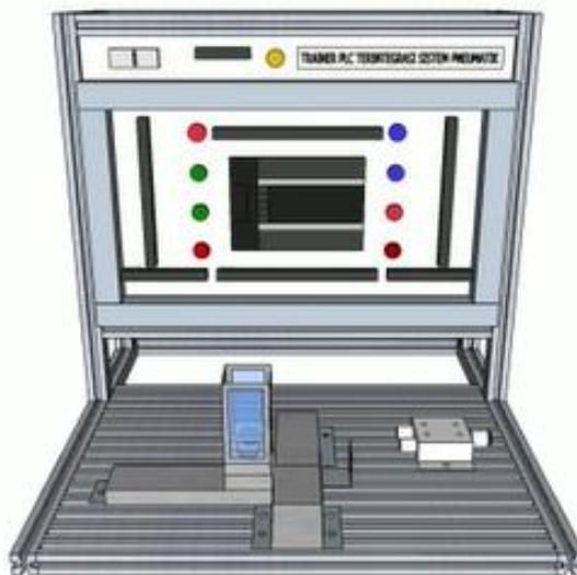
Gambar 2. Desain Trainer PLC Terintegrasi Sistem Pneumatik
