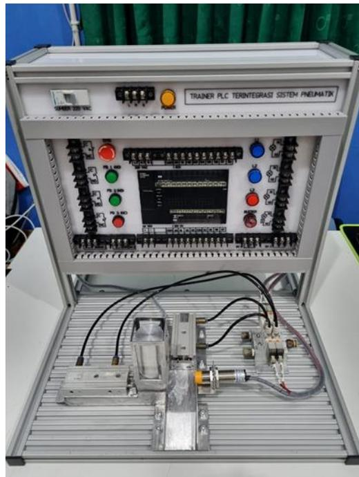
Gambar 3. PLC terintegrasi Sistem Pneumatik
